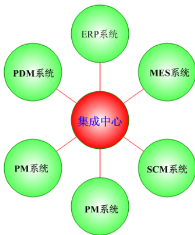
中心——辐条 (hub-spoke) 式体系结构
