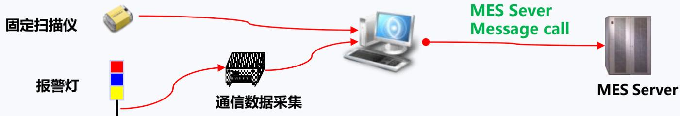
工序Inter-Lock功能是指在产品制造工序中，为防止不良产品产生并及时应对异常状况，以预设的制约条件为依据进行的控制的流程
