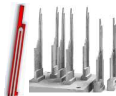
内部冷却流道提高使用寿命
