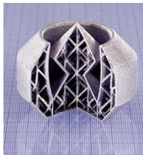
内空结构减轻零件重量
