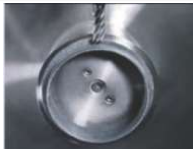
3. 铣削法兰平面
