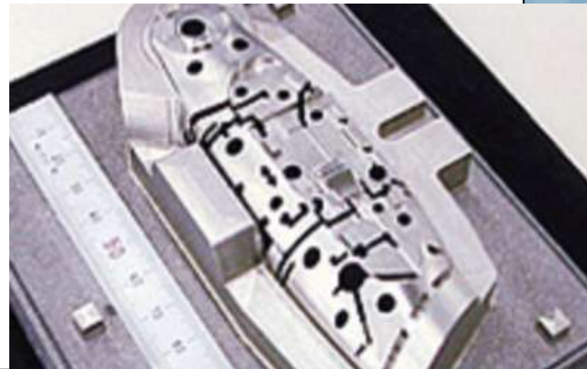
激光烧结和铣削制成的模具
