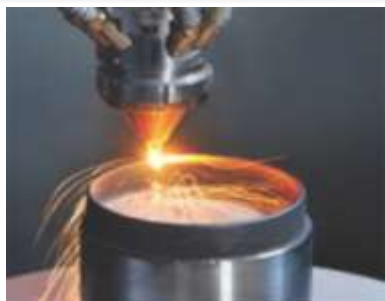
1. 激光堆焊圆柱环
