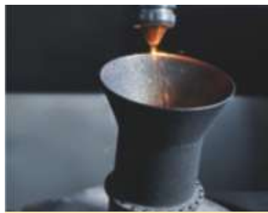
7. 堆焊锥形管道
