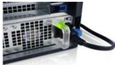
電源把手上的閃爍燈使故障的診斷更加容易
